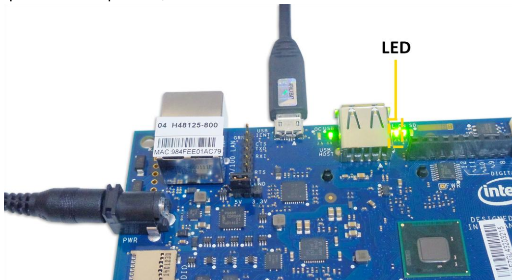
Figura 4: Placa Intel Galileo com ênfase no LED que demonstra que a placa está ligada.
